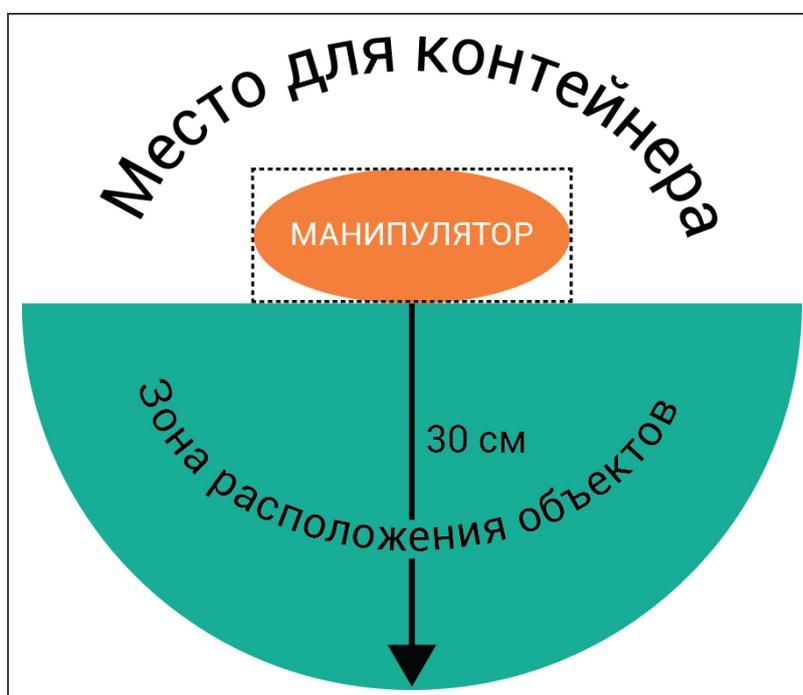
Рисунок 1. Размещение объектов на рабочем поле.
